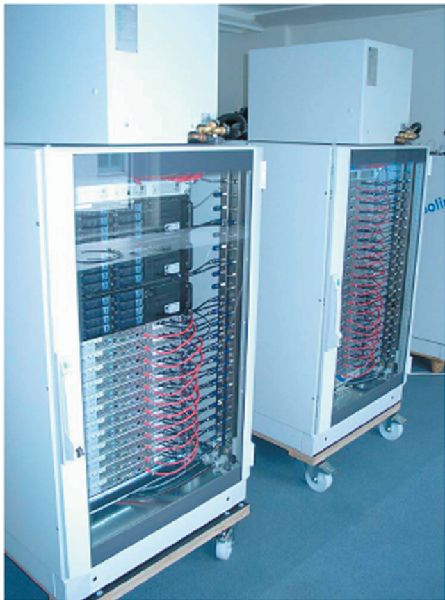
FIGURA 5.- "CLUSTER" QUE PROCESA Y GUARDA LAS FOTOS DEL DOT. EN LA FOTO SE APRECIAN LOS CABLES NEGROS QUE SON LOS TUBOS DE ENFRÍAMIENTO POR AGUA)
