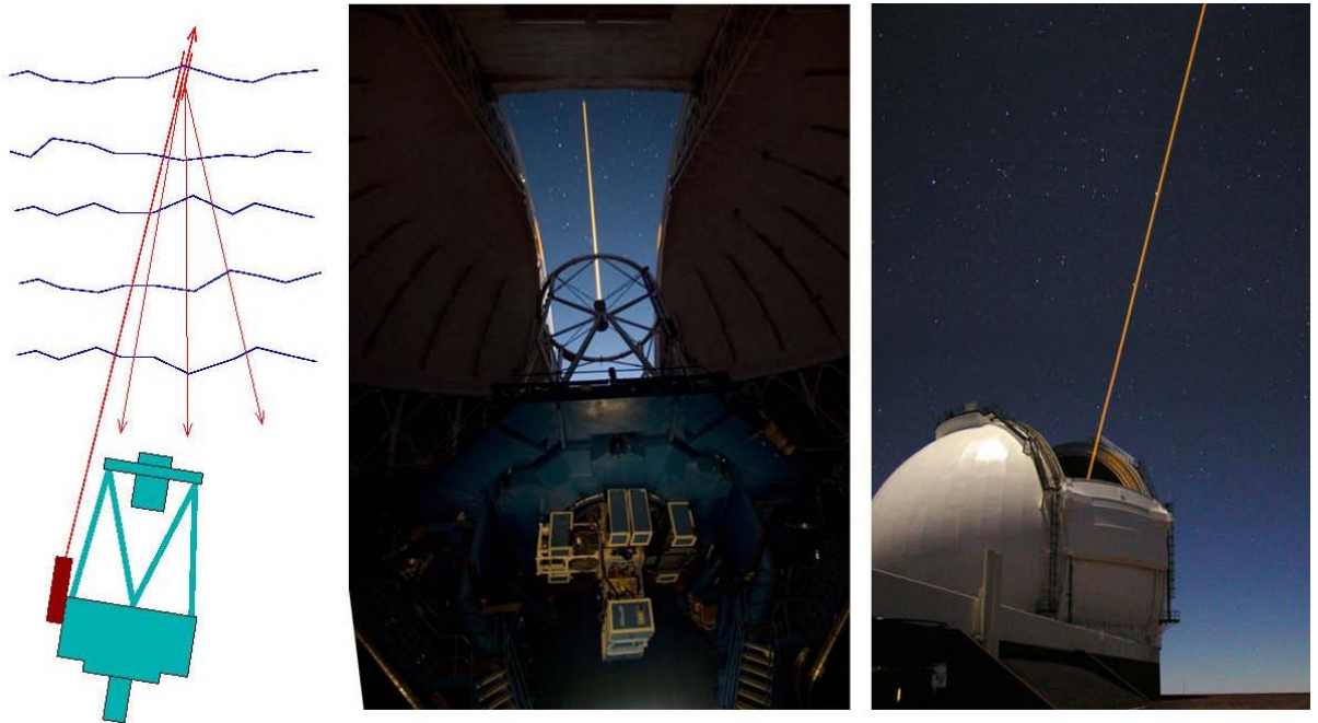
Obr. 5 Vľavo : Princíp adaptívnej optiky využívajúcej umelú hviezdu vytvorenú laserom. Uprostred : Lúč laseru adaptívnej optiky ďalekohľadu Gemini počas pozorovania. Vpravo : Kupola ďalekohľadu Keck s lúčom laseru adaptívnej optiky v činnosti. Lúče sú voľným okom neviditeľné a zachytí ich len snímka s dlhým expozičným časom.
