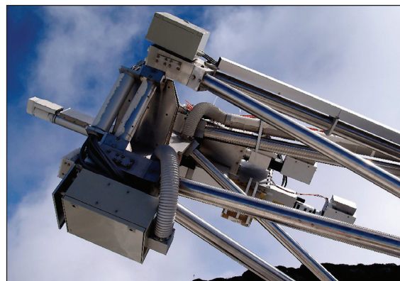
Primárne ohnisko hlavného zrkadla s filterami a kamerami. Hadice slúžia na odsávanie vzduchu.
